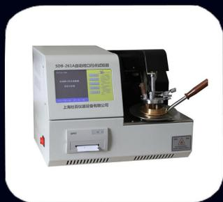
型号：SDB-261A 参照标准：GB/T261, ASTM D93
