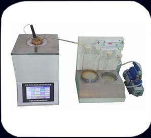
型号：SDB-0059B 参照标准：SH/T0059 B法, ASTM D5800 B法
